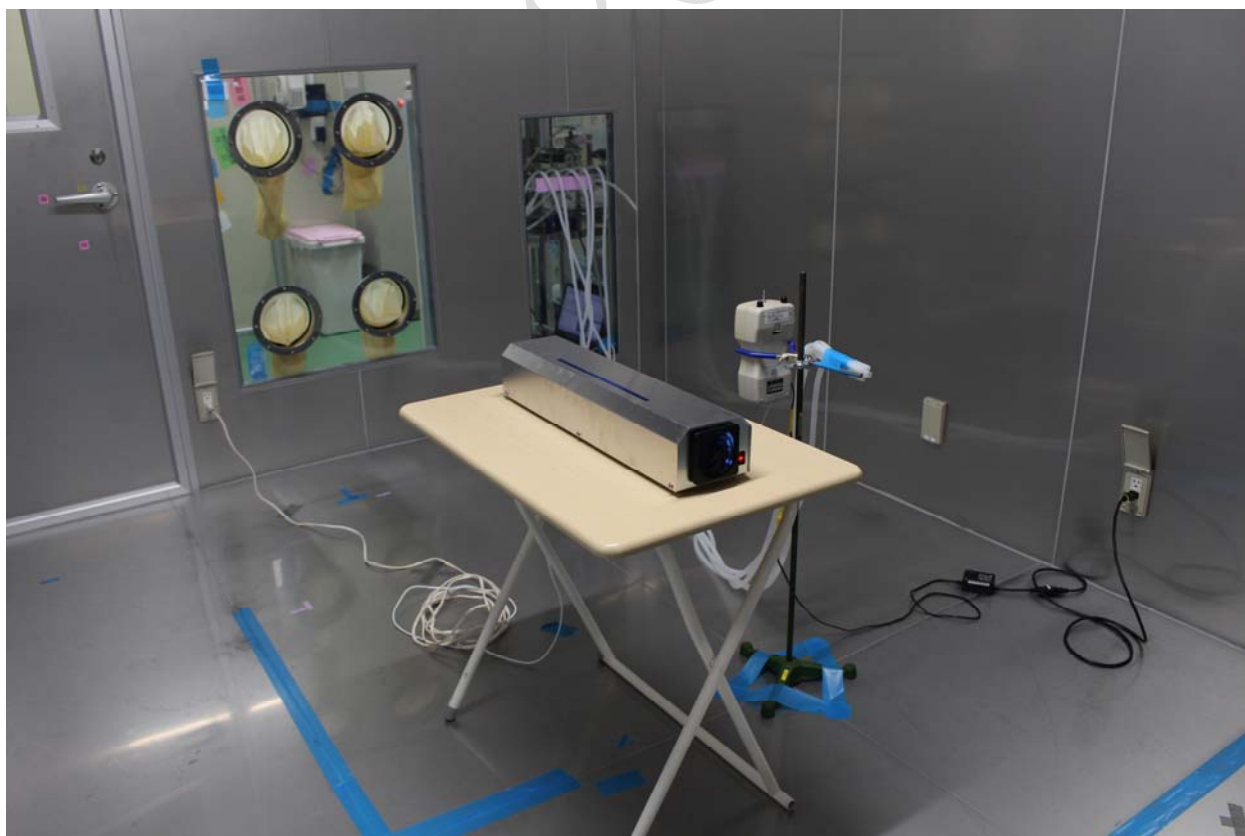
別紙図 b1. 「エア美人」試験時の 25 m 3 試験チャンバーの様子
